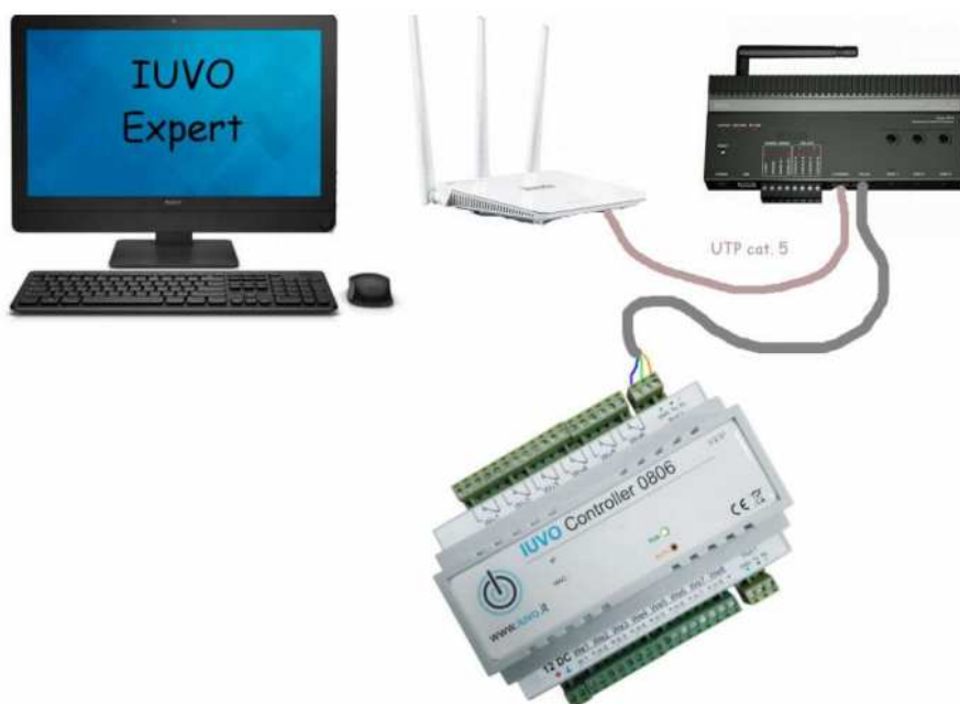
Rys. 1. Schemat podłączenia sterownika IUVO oraz serwera XP3
